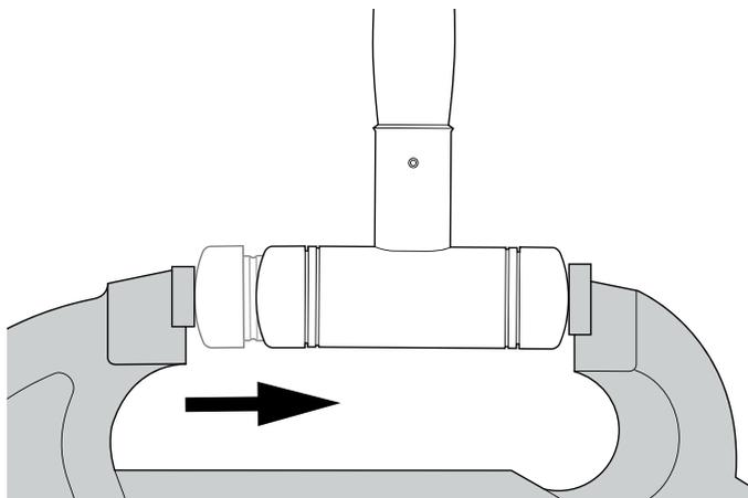
Einpressen des neuen Schlagkopfes in Schraubstock.
