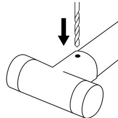
Stiel mit Bohrer wie Lochgröße durchbohren
