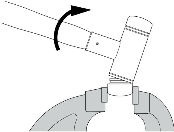
Hammer in Schraubstock einspannen, durch Anheben alten Schlagkopf entfernen.
